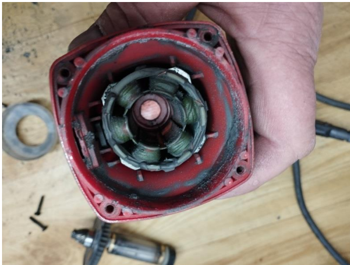
Obr.2 Znečistenie puzdra motora a statora
