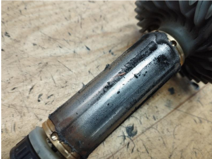
Obr.1 Znečistenie rotora kovovým prachom
