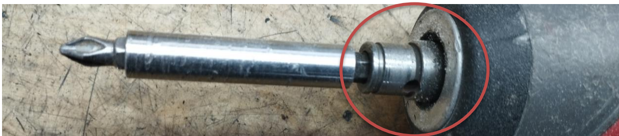
Obr.2 Chýbajúci mechanizmus upínania
